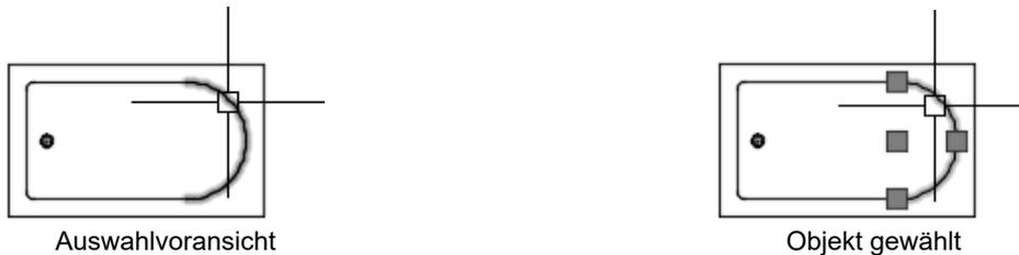
Bei der Objektwahl wird ein sogenannter Auswahlsatz gebildet. Werden weitere Objekte gewählt, wird durch ein Plus am Fadenkreuz deutlich gemacht, das diese Objekte zum Auswahlsatz hinzugefügt werden.
